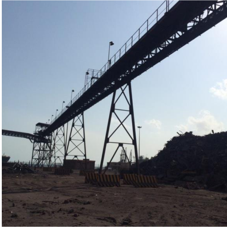
صورة رقم (31) النقل بالسيور أحد طرق نقل الحديد الخام داخل الشركة.
